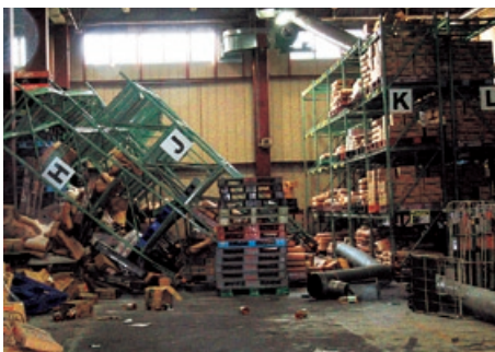
大震災時の一般倉庫内
